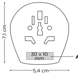
Zuverlässige und einfache Verbindung für Geräte aus der ganzen Welt mit dem europäischen Normstecker, inkl. integriertem USB-Ladegerät für zeitgleiche Verwendung. Geeignet für geerdete und ungeerdete Stecker (2- und 3-polig) sowie USB-Geräte. Steckdoseingang für: Schweiz, Italien, Australien/China, UK, USA/Japan und Brasilien.
